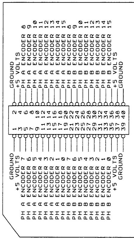
ALL ENCODER INPUTS ARE TTL LEVEL PULLED HIGH THROUGH
